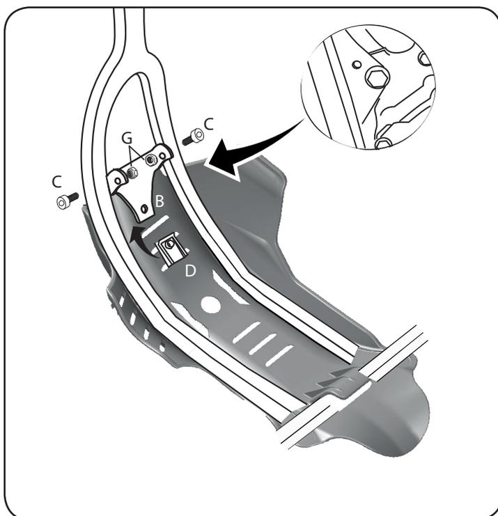
2. Assemblare la clips sulla staffa e fissare la staffa sul telaio come indicato.
