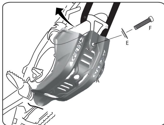
3. Avvitare il sottomotore al telaio.
